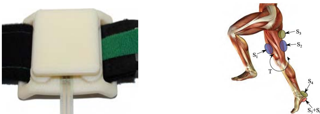
Figura 4.27. Senzorii pentru monitorizarea activității musculare și modalitatea lor de dispunere pe membrul inferior sănătos [31]
