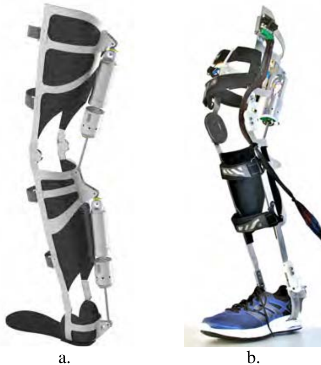
Figura 4.25. Exoscheletul KIT-EXO1: modelul CAD (a), prototipul (b) [31]
