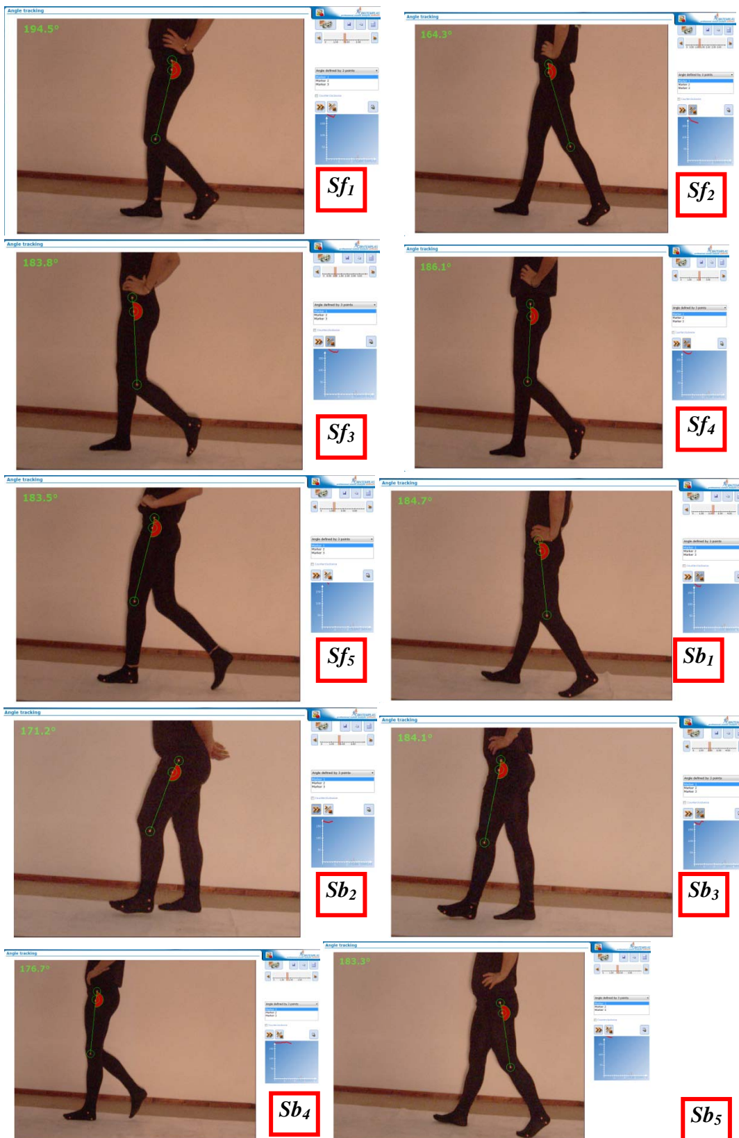
Fig. 2.9 Desfășurarea activității de pășire a membrului inferior uman în vederea generării amplitudinii unghiulare a articulației soldului cu ajutorul soft-ului CONTEMPLAS, corelată cu platforma de forțe RSscan
