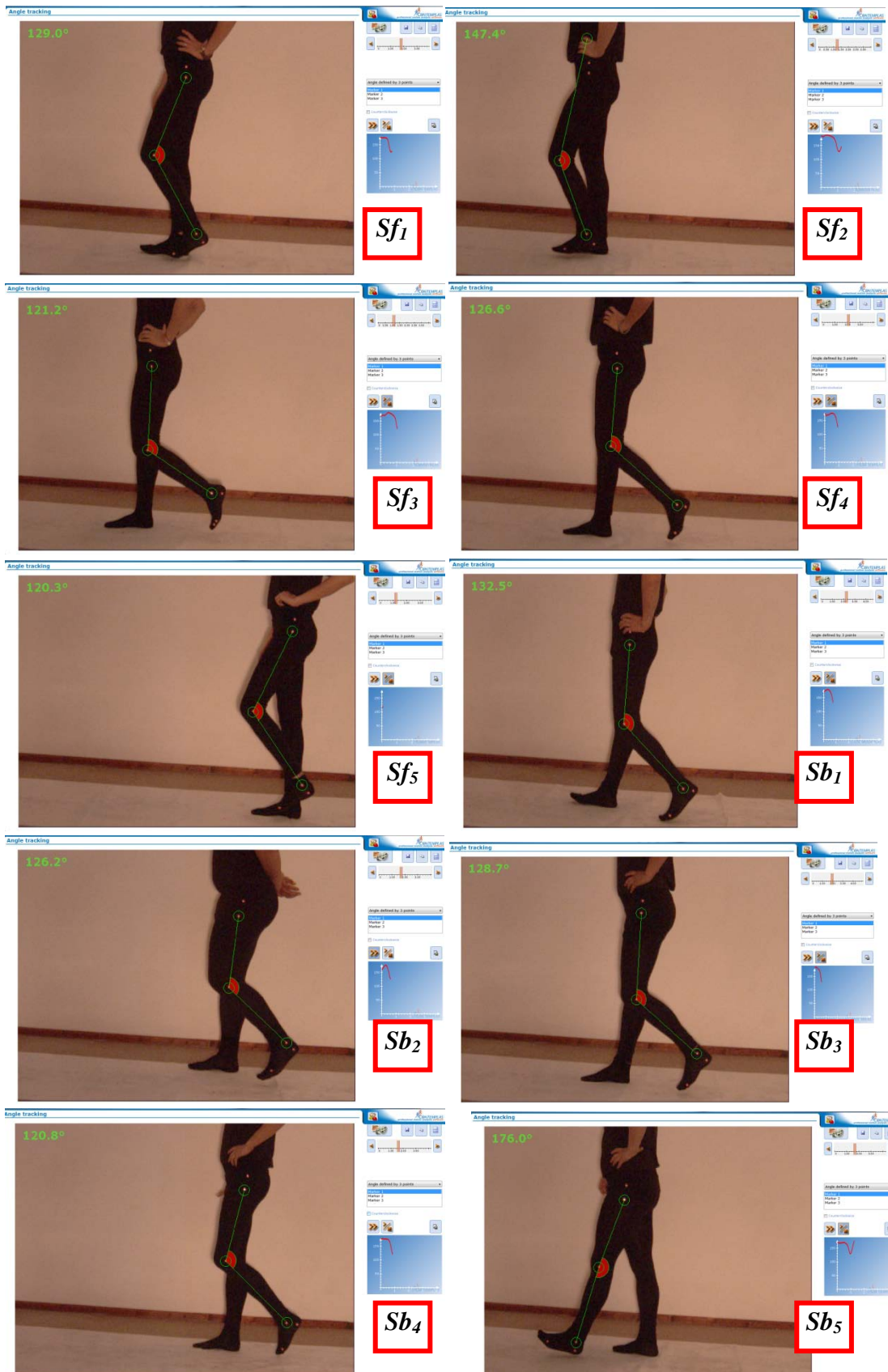
Fig. 2.10 Desfășurarea activității de pășire a membrului inferior uman în vederea generării amplitudinii unghiulare a articulației genunchiului cu ajutorul soft-ului CONTEMPLAS, corelată cu platforma de forțe RSscan
