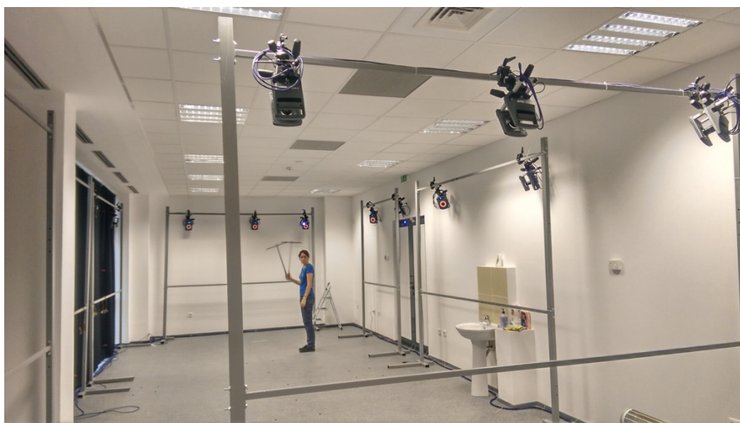
Figura 2.13. Calibrarea camerelor cu Wand-ul
