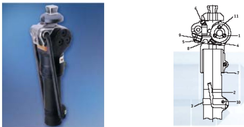
Figura 7.30. Modelul mecanismului exo-protetic de tip K4 modular; a – aspect general, b – aspect constructiv.
