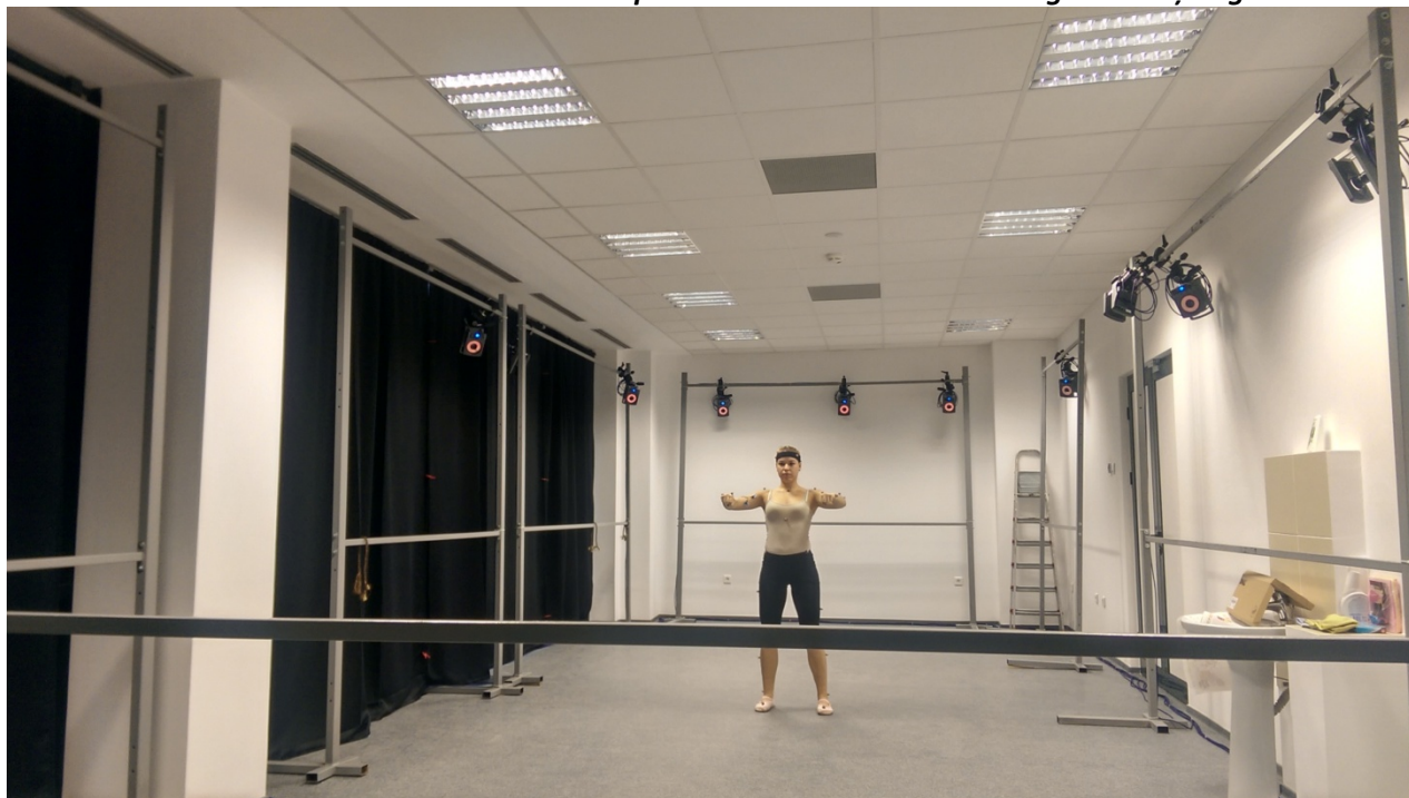
Figura 3.12. Poziționarea subiectului uman pentru captarea markerilor și generarea exoscheletului în modul static
